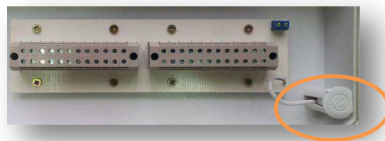
клеммный блок РМ2 до 2,5 мм 2 (AWG 22-14) 300В 15А
